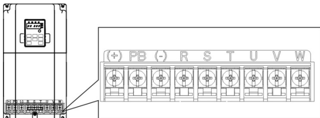
Рис. 4-4 Клеммы подключения силовых цепей
